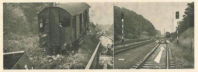
Güterwagen nach Überfahren des Gleisabschlusses in einen Graben stürzte, kam der Gepäckwagen auf dem Erdkegel zum Stillstand.
