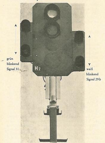
Durch die Errichtung ferngesteuerter Bf sowie für besonders gelagerte Fälle ist es notwendig geworden, ein Lichtsignal 30 zu entwickeln. Ein solches steht seit 2. September 1968 im Bf Baden Fbf in Erprobung.
