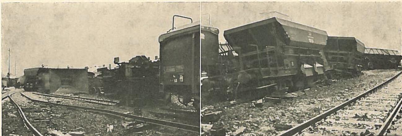
Am 15. November 1968 um 14.48 Uhr entrollten beim Verschub eines Bedienungszuges in einer Anschlußbahn zwischen den Bf St. und G. 17 vorübergehend am Streckengleis abgestellte Wagen (600 t, 40 Achsen, bis auf einen Wagen alle beladen) und rollten 8,9 km bis in den Befehlsbf K.
