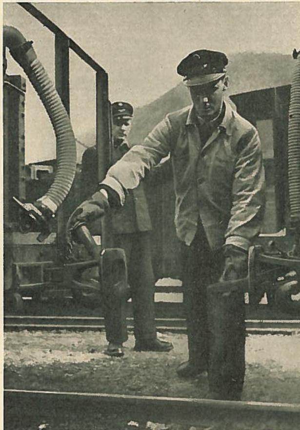
der Kupplungsbolzen des stillstehenden Fahrzeuges durch Heben und Schrägstellen im Bolzenloch in die Bereitschaftsstellung zu bringen ist und daß die Bremsschläuche vor dem Zusammenschieben der Wagen von den Blindmuffen abzuheben sind! (Besonders beim Kuppeln im Gleisbogen darauf achten!)
