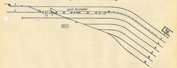
Der auf Gleis 2 gegenüber der Fahrdienst-leitung des in der Skizze dargestellten Bahnhofes stehende Wagensatz eines Personenzuges soll von der Zuglokomotive bis über die Weiche 3 geschoben und von dort in Gleis 12 gezogen werden. Der Fahrdienstleiter stimmt dem geplanten Verschub zu. Stellwerk 1 wird durch den Verschubleiter von der bevorstehenden Bewegung
