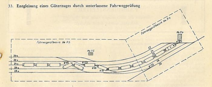
Bei Bildung eines Güterzuges in einem großen Verschiebebahnhof läßt der Verschubleiter mit Wissen und Zustimmung des Wärters des Weichenpostens 5 eine Gruppe von 10 Wagen von Gleis 26 über die örtlich bedienten Weichen 131, 126, 123 und 113 nach Gleis 24 a zurückschieben, weil Gleis 26 allein für die Aufstellung des ganzen Zuges (88 Achsen) nicht ausreicht.
