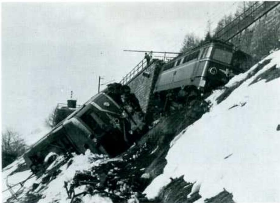
Dienstag, 29. 1. 1980 um 17.28 Uhr überfuhr Lz 68305 (Tfz 1043.09 und 1042.02, Böckstein—Spittal-M.) unerlaubt das haltzeigende Ausfahrtsignal im Bf Penk sowie den etwa 120 m danach befindlichen Gleisabschluß 2 und stürzte auf die anschließende Böschung. Glücklicherweise wurde niemand verletzt, es entstand jedoch erheblicher Sachschaden.
